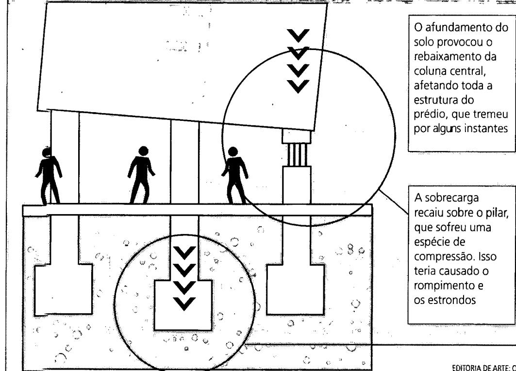
O afundamento do solo provocou o rebaixamento da coluna central, afetando toda a estrutura do prédio, que tremeu por alguns instantes
