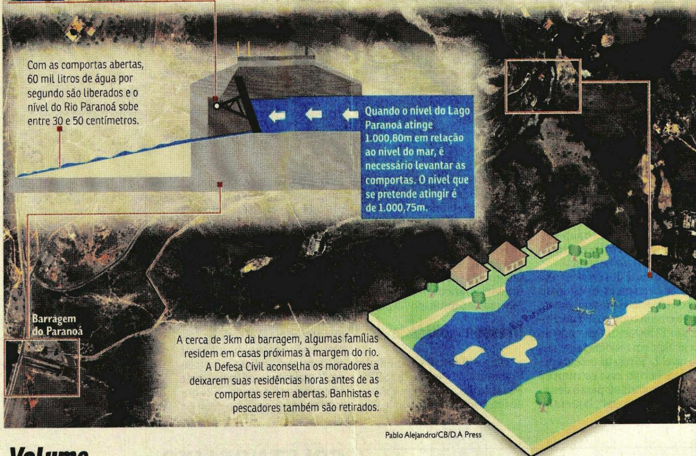
Com as comportas abertas, 60 mil litros de água por segundo são liberados e o nível do Rio Paranoá sobe entre 30 e 50 centímetros.
