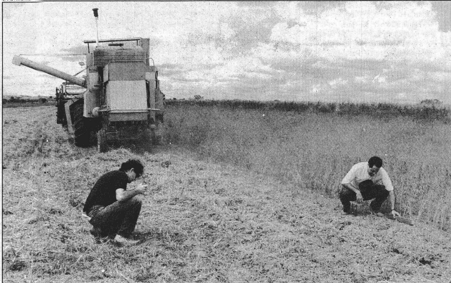
Uma colheitadeira mal regulada pode até jogar fora acima de 30 por cento dos grãos produzidos numa cultura como a soja
