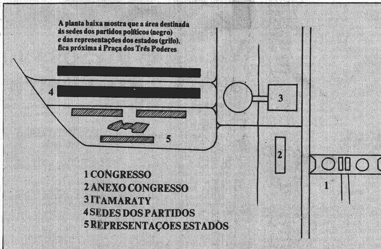
A planta das representações dos Estados é do arquiteto Oscar Niemeyer. São três blocos de dois pavimentos sobre pilotis, com 160 metros de comprimento e 19 de largura. Entre os três blocos, será reservada uma área para a construção de um prédio que abrigue serviços comuns, com auditórios, restaurantes e bancos. O GDF cederá a área, mas todos os Estados vão ter que arcar com os custos das obras, cujo preço ainda não está definido. São Paulo requereu sete módulos na área.
