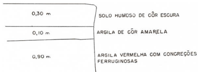
Fig. 119 – Perfil do solo a cerca de 1.500 metros do quilômetro zero na estrada para Fazendinha.
