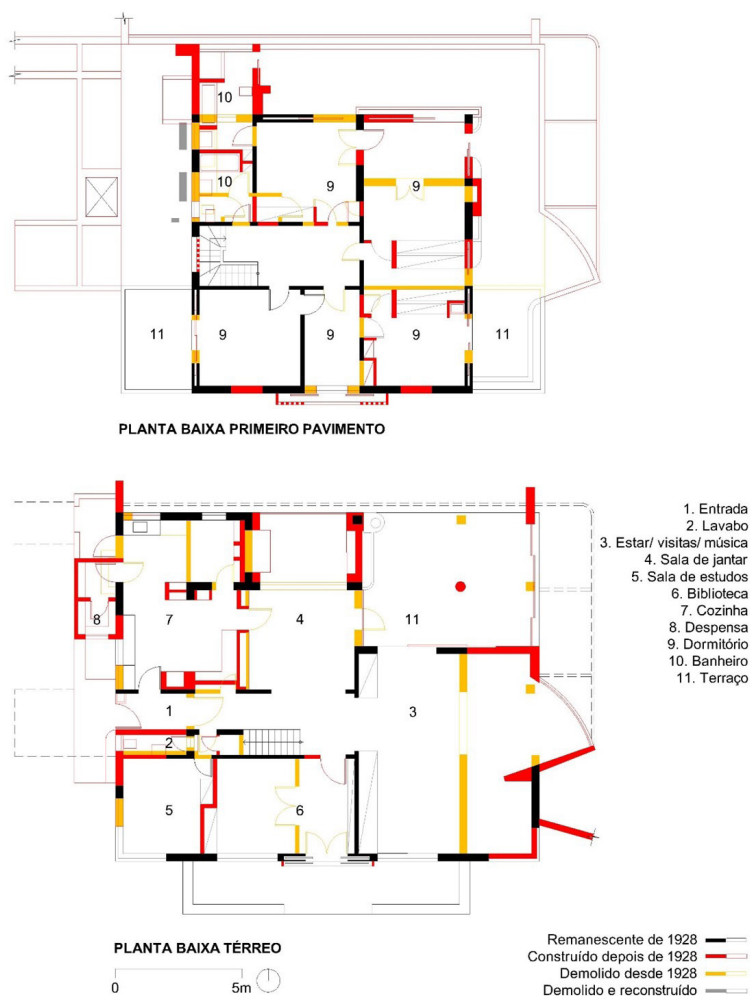
Figura 7.15 Planta-síntese das transformações sofridas pela Casa da Rua Santa Cruz de 1928 a 2008, indicando os usos de 1935. É possível observar as transformações de 1934-35 e aquelas posteriores. O desenho resulta da sobreposição dos registros de 1927, 1934 e 2008.
