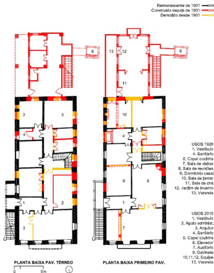
Figura 9.5 Planta-síntese das transformações sofridas pelo Palacete Argentina de 1901 até o presente, indicando os usos de 1928 e 2015. É possível observar as transformações de 1928 e aquelas posteriores a 1984, quando se instalou a sede local do Iphan.
