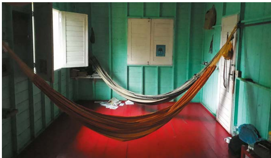
Figura 65. Quarto com aberturas em dois lados, para ventilação cruzada.
